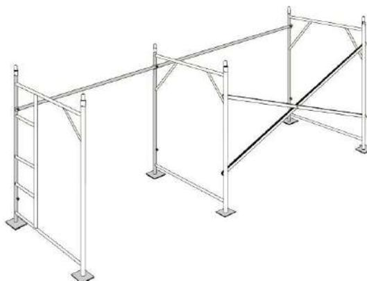
4- Após a montagem dos painéis do primeiro piso, colar as plataformas metálicas, antes de iniciar a montagem do piso superior.
