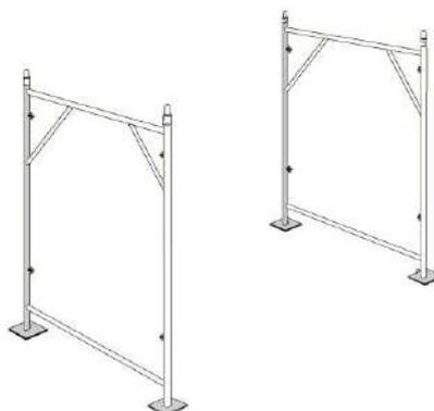
2- Conectar os dois painéis de andaime fixando-os com o "X" de travamento, através das travas do painel.
